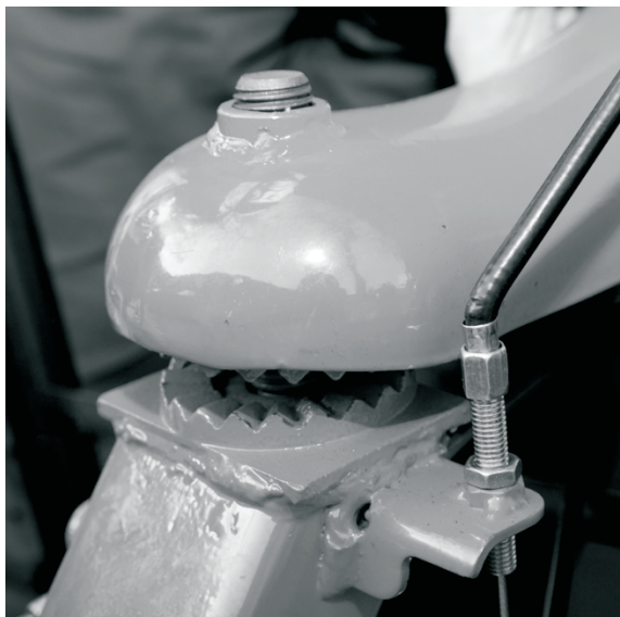
ШАГ 4 Совместите вал рукоятки управления с установочной опорой.
