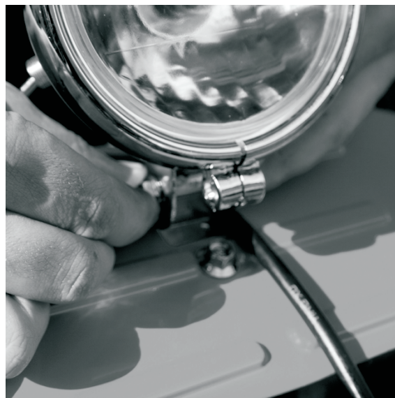
ШАГ 14 Установите фару на штатное место и закрутите гайку.
