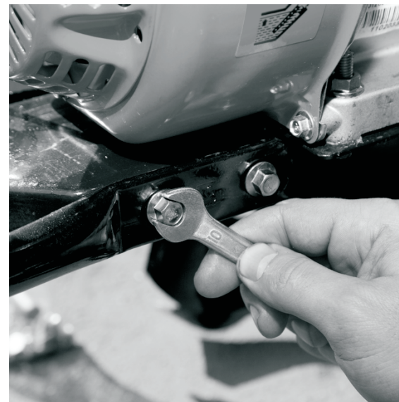
ШАГ 15 Установите передний кронштейн.
