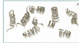
Свободно намотанная (витая) стружка - идеальные условия резания
